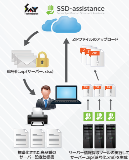
(図2) SSD-assistanceを利用したサーバー仕様書作成のフロー。サーバーごとに情報採取ツールを実行し、出力されたZIPファイルを専用ポータルにアップロードすると、数分でExcel形式の仕様書が送られてくる
